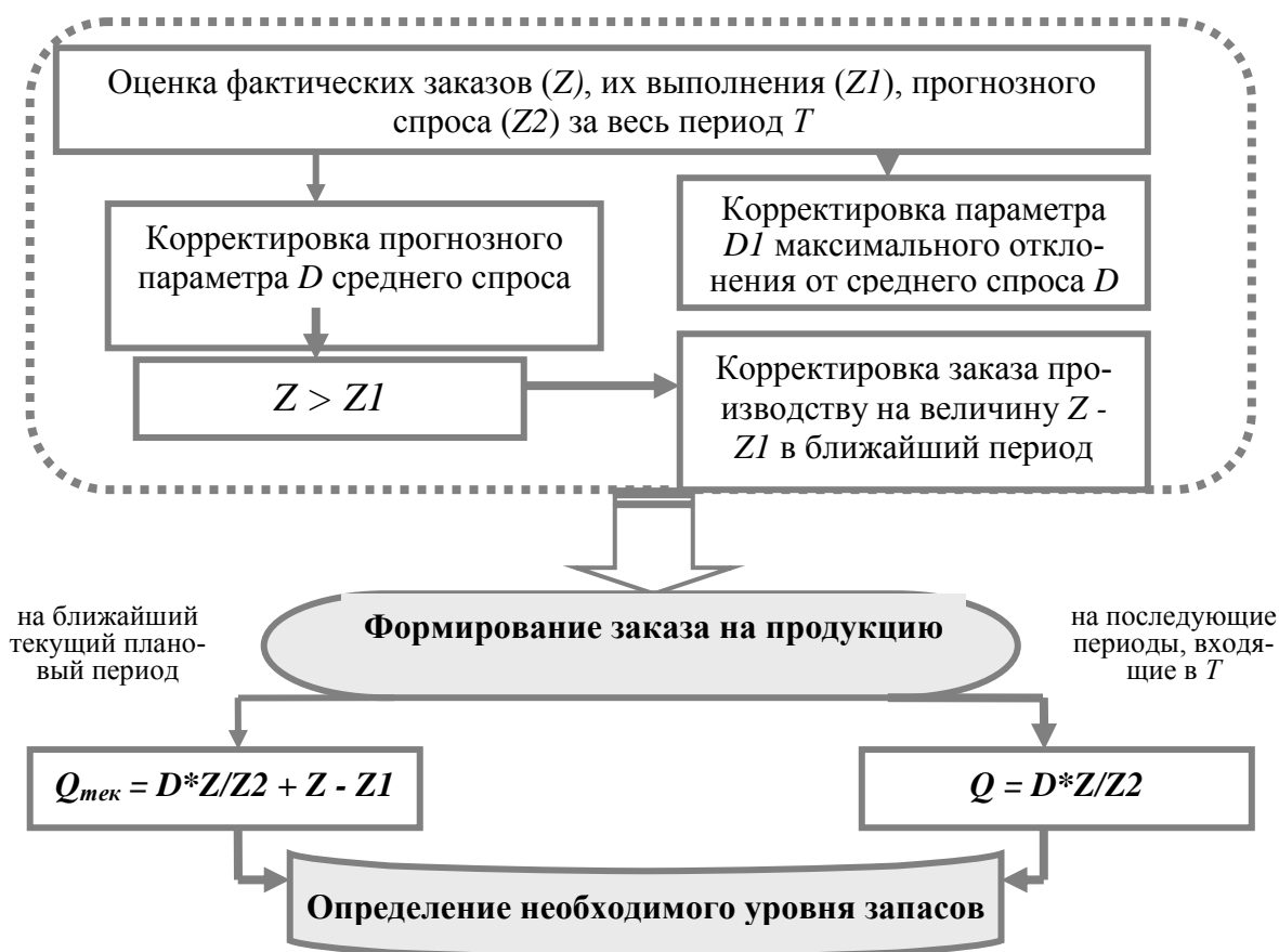
Рис. 2. Порядок корректировки основных параметров системы оперативного производства и формирования заказов на продукцию
