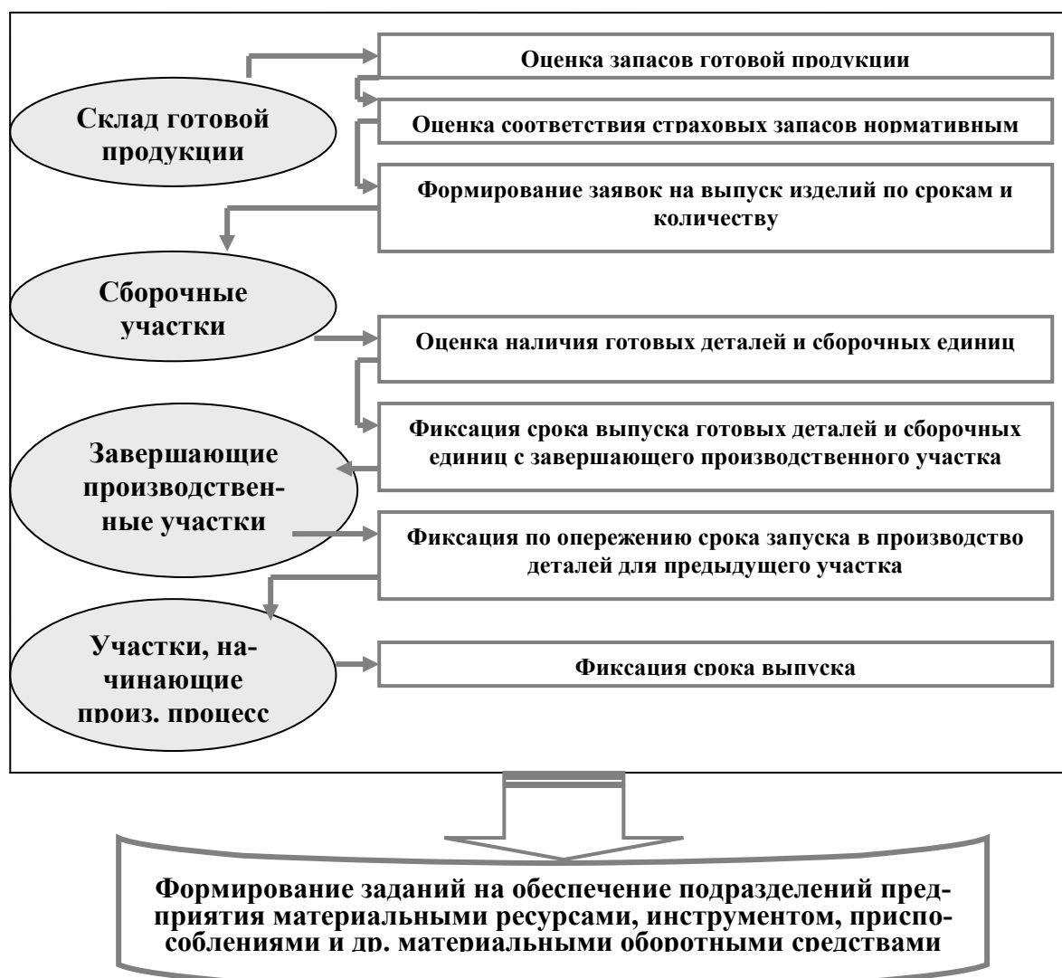
Рис. 3. Порядок формирования оперативных заданий производственной программы и её обеспечения
